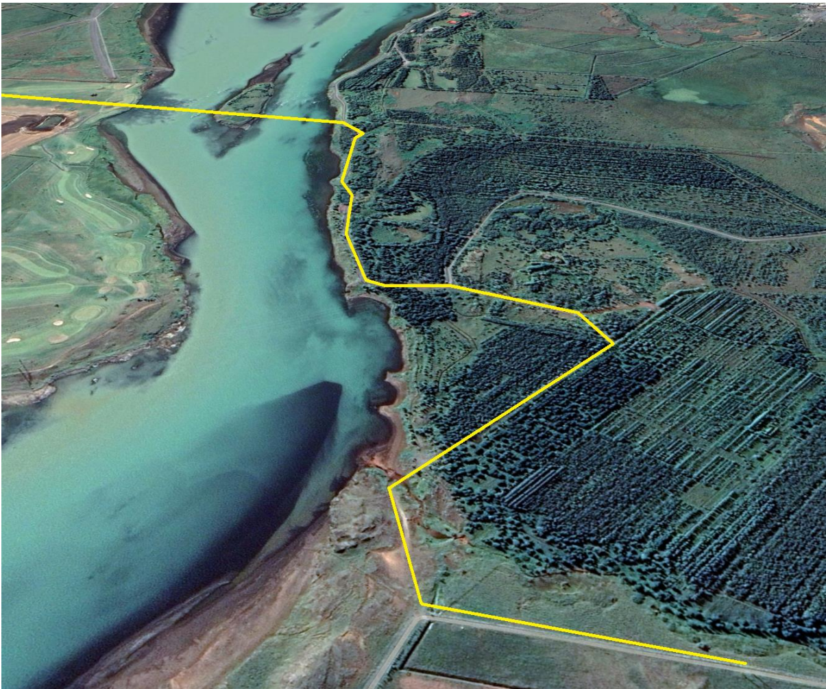
Mynd 3.4 Lega nyrðri hluta jarðstrengsins þar sem hann fylgir vegslóða í gegnum Hellisskóg. Mynd: Google earth.
