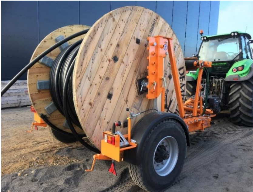
Mynd 3.6 Strengjakefli á keflavagni sem notað er við lagningu jarðstrengs.
